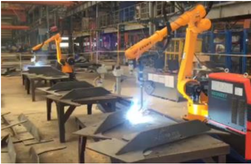
机器人焊接应用
